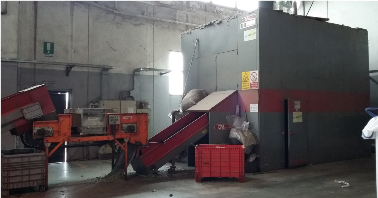
FOTOGRAFIA N. 5 – LINEA DI TRATTAMENTO A (DEFERRIZZATORE E GRANULATORE)
