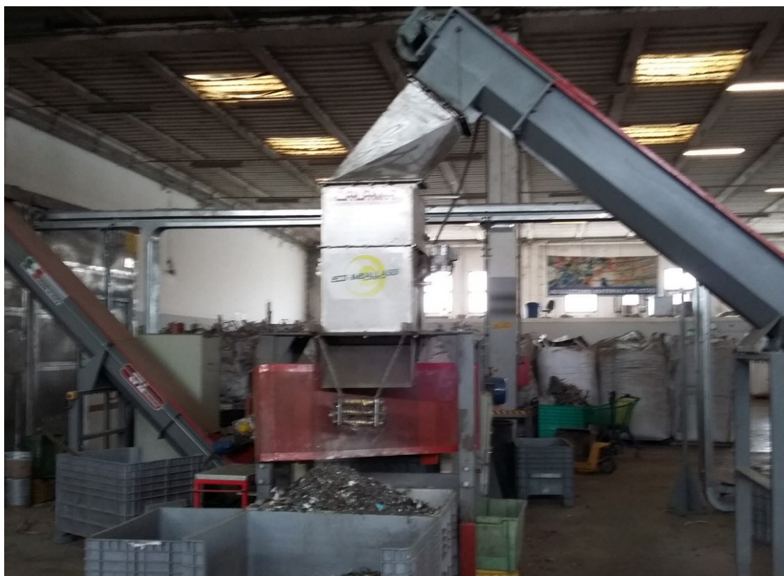
FOTOGRAFIA N. 3 – LINEA DI TRATTAMENTO B (DEFERRIZZATORE)
