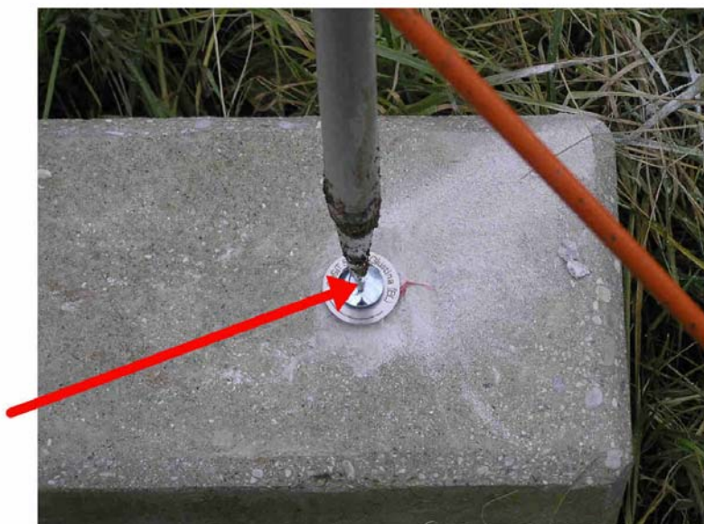
Figura 3: caposaldo CS3 di rilievo sulla spalla del nuovo ponte in via Parenzo
