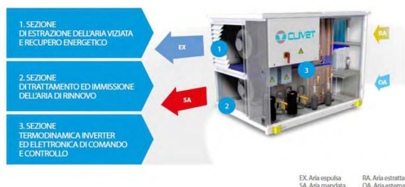
Le modalità di funzionamento prevedono di poter lavorare sia a tutt'aria esterna che con un'aliquota parziale di ricircolo in funzione delle condizioni di affollamento; allo scopo di controllare la qualità dell'aria saranno installati sensori di rilevazione del CO e sulla base di tale segnale sarà regolato l'apporto di aria esterna.
