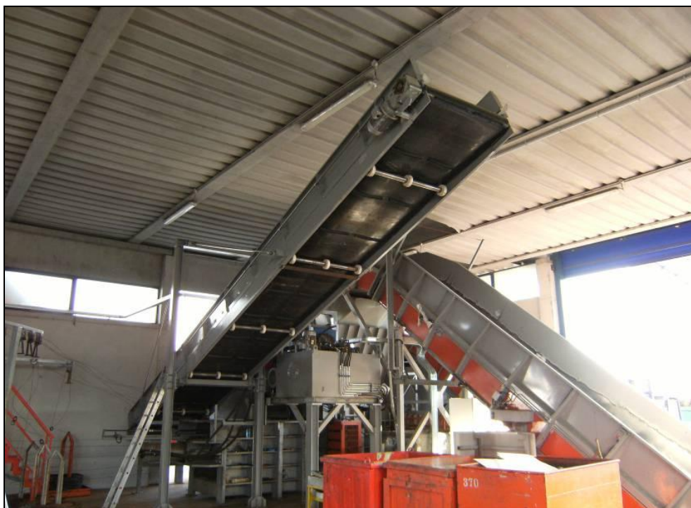
Fotografia 8 – Nastro trasportatore per l'allontanamento del sopravaglio
