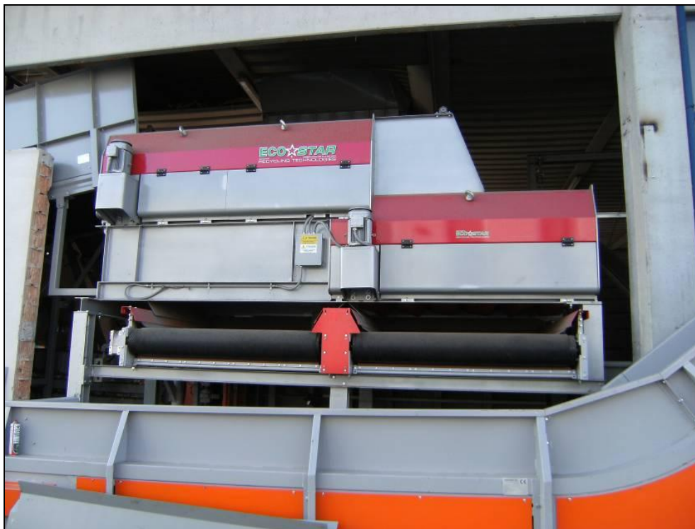
Fotografia 9 – Uscita del sovrvallo dal vaglio dinamico a dischi
