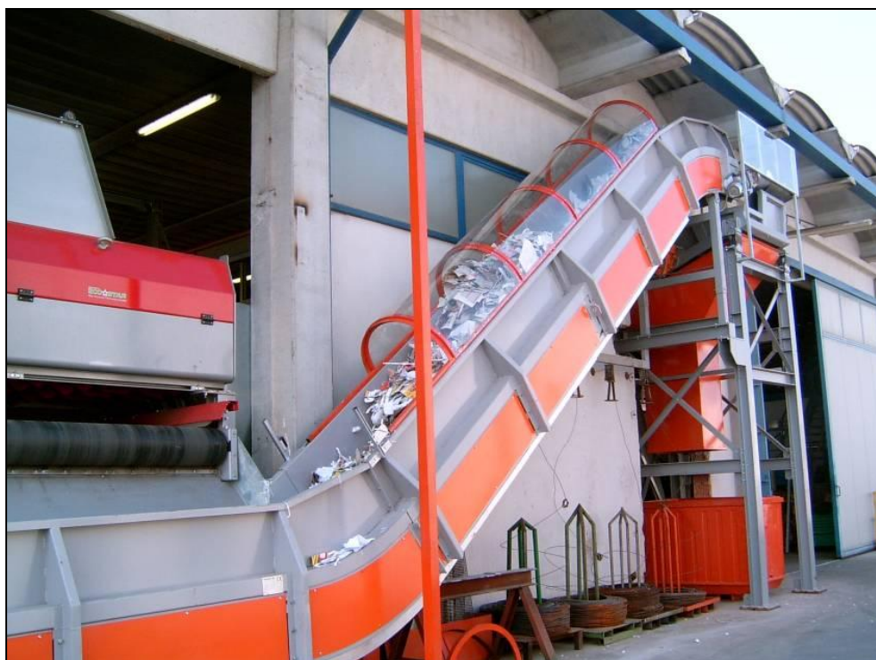
Fotografia 10 – Passaggio del sovrvallo dal vaglio a dischi al vibrovallo dinamico
