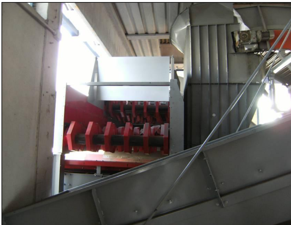
Fotografia 7 – Uscita posteriore del vaglio dinamico a dischi
