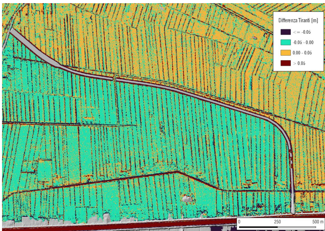
Figura 31: differenza dell'involuppo dei tiranti tra lo stato di progetto e lo stato di fatto per l'area di interesse.
