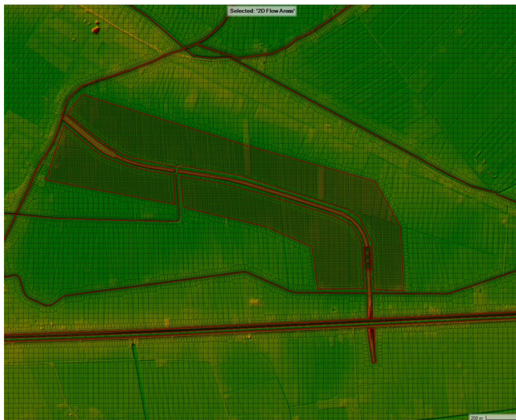
Figura 16: porzione della mesh di calcolo, area di intervento con celle di dimensione variabile da 2m x 2m a 10m x 10m.
