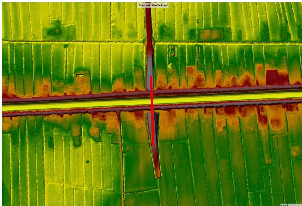
Figura 33: sezione utilizzata per l'estrazione del tirante sul canale Cavetta.
