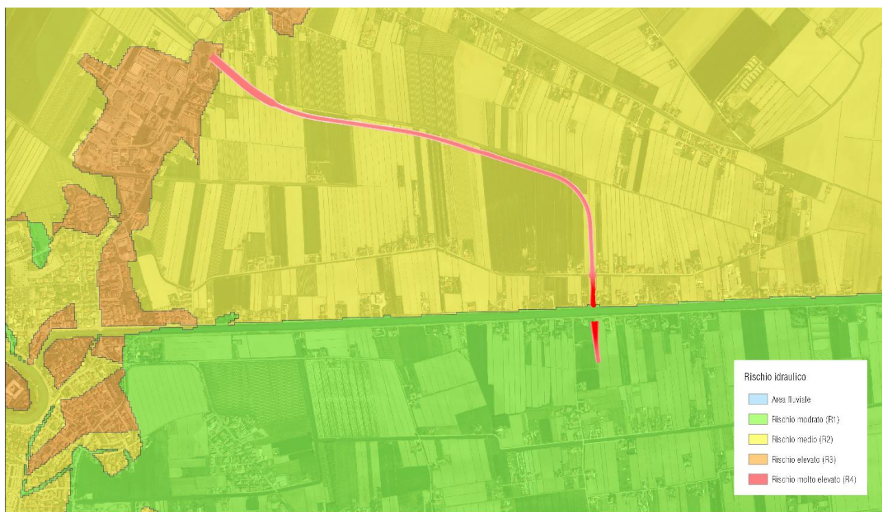
Figura 4: carta del rischio idraulico, l'intervento ricade in zona R1, R2 e R3.
