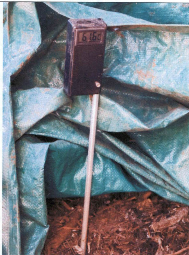
Foto 12 – sonda per misura T di processo
