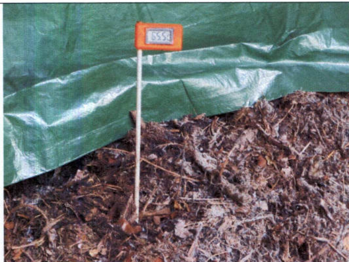
Foto 7 – sonda per misura T di processo
