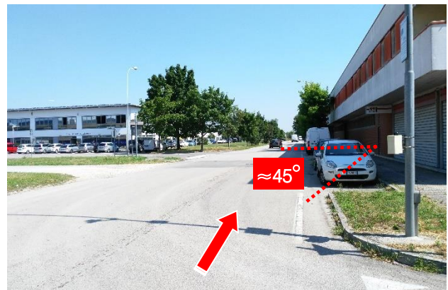
Figura 25 – Angolo di installazione dei radar rispetto alla direzione di marcia
