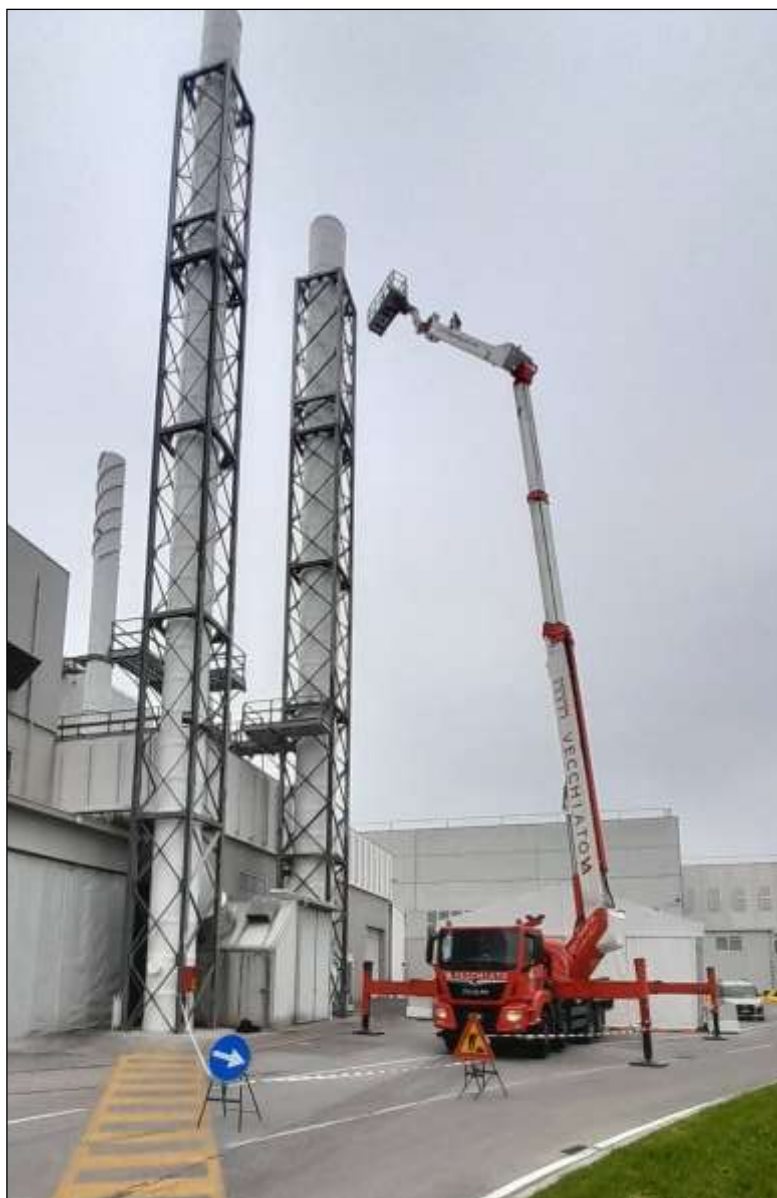
Figura 5 Piattaforma elevabile autocarrata utilizzata per le misure di caratterizzazione dei camini.
